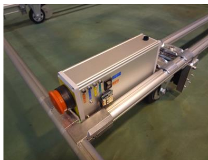
図 2-5 ロボットの制御 BOX
